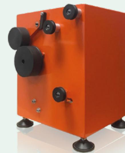
RheoSpin è uno strumento versatile che permette di misurare le proprietà reologiche in flusso elongazionale non isoterma - informazione utile e pressoché necessaria per la determinazione della filmabilità e la filabilità dei sistemi polimerici - per produrre fibre con differenti rapporti di stiro per verificare l'effetto dell'orientazione sulle proprietà meccaniche.
